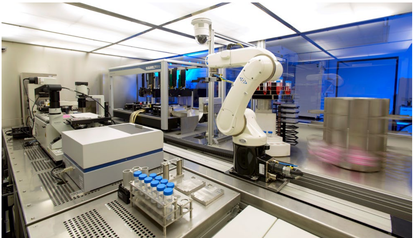
Abbildung 11: StemCellFactory: Automatisierte Plattform für die hiPSC-Produktion. Standort: Bonn, Deutschland.
