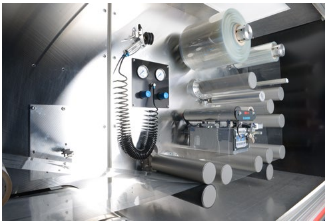
Abbildung 16: Herstellung mikrofluidisch strukturierter Folien in einem Rolle-zu-Rolle-Verfahren.
