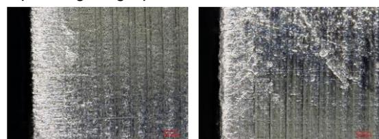
Abb. 10: Stempel (1.2379) unbeschichtet nach ca. 1000 Schneidtests von CFK (links) und GFK (rechts) (Lichtmikroskop 500-fach)
