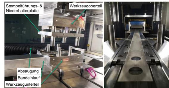
Abb. 14: Folgeverbundwerkzeug auf der Servopressenlinie am Fraunhofer IPT
