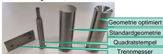
Abb. 13: Aktivteile für das Folgeverbundwerkzeug
